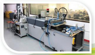
紙盒打膠貼輔料線採用了模组式結構設計•由自動絲印機•視覺機器人和產品流水線組 成:完成在紙盒上絲印膠水•粘貼輔料等一系列動作8自動絲印機和視覺機器人可以根 據生產需要移至其它產線上使用。
